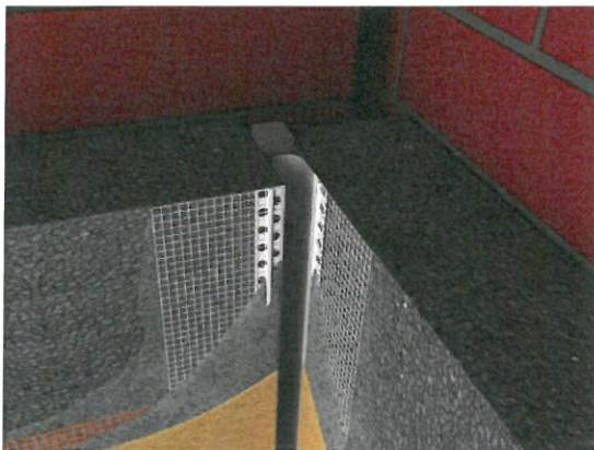
Rys.2 Szczelina dylatacyjna w narożu budynku
